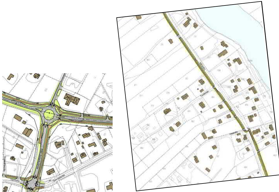
Kuva 43. Ote kt79 yleissuunnitelmasta, Rovaniementien ja Sodankyläntien risteysalueen kiertoliittymä (vas) ja Alakittilän Vanhatien varrelle suunnitella oleva kevyen liikenteen väylä (oik).
